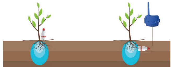
Instalación de superficie y mediciones puntuales
